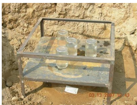
图2 试坑注水法试验装置图
